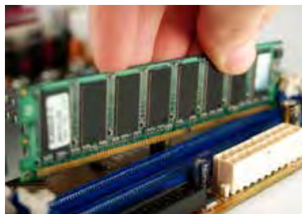
Pente de memória RAM sendo encaixado
