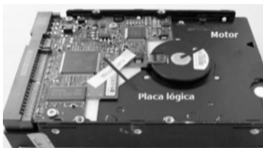
HD indicando a placa lógica e o motor
