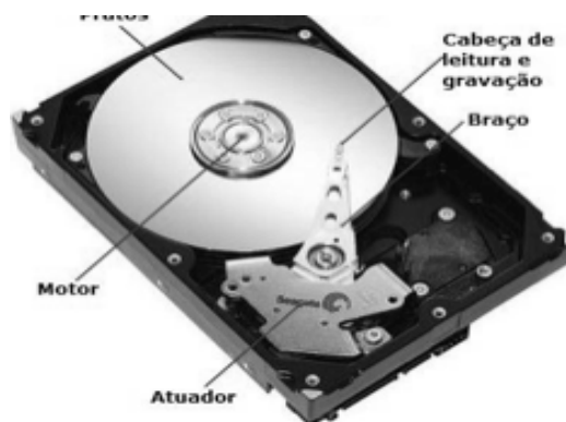
HD indicando os discos, motor, atuador, cabeça de leitura e gravação e braço
